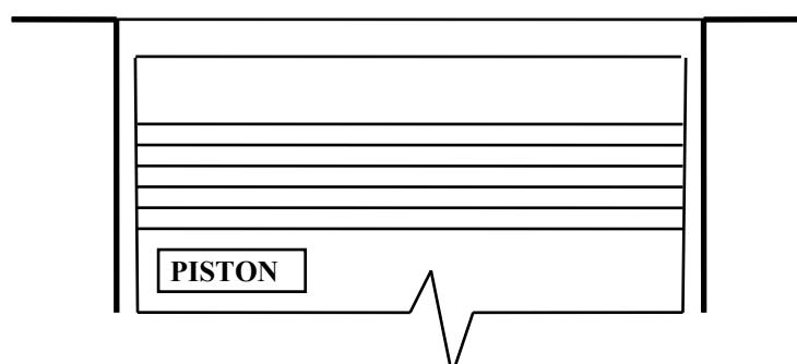
**THE PISTON MUST NOT PROTRUDE ABOVE THE CYLINDER BLOCK TOP FACE.**
